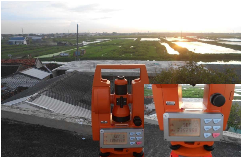
Gambar 4.2 Hasil Pengukuran Arah Barat Sejati Menggunakan Theodolite 17
