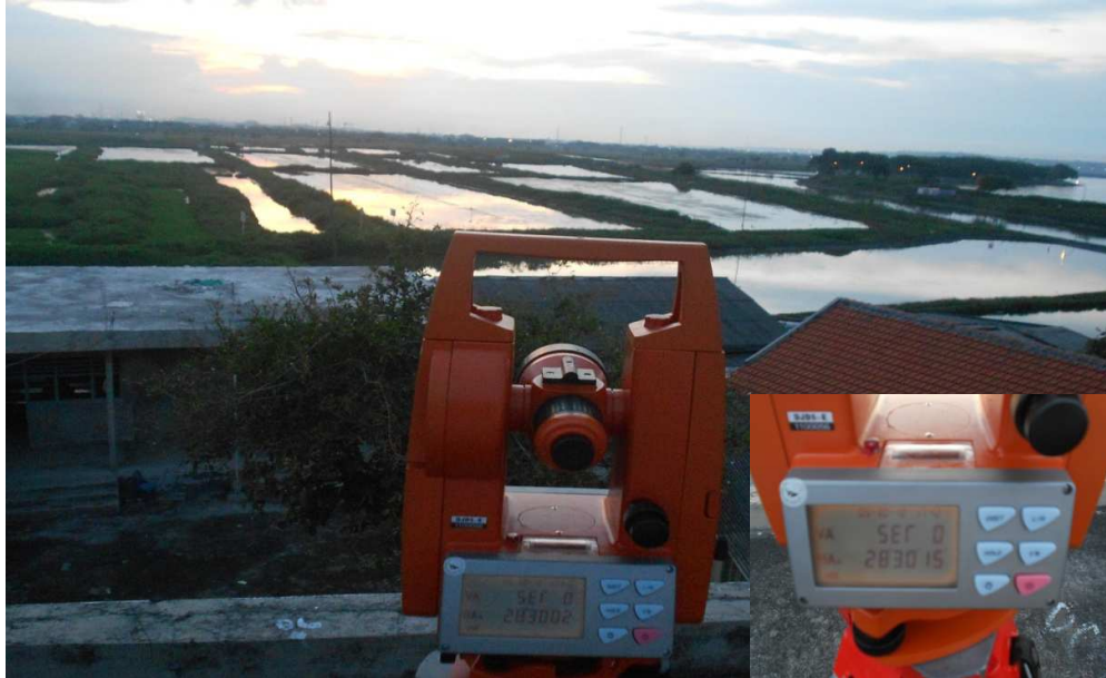
Gambar 4.3 Hasil Pengukuran Azimuth Terjauh Bulan ke Utara Menggunakan Theodolite 18
