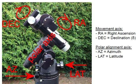
Gambar 3.7. Bagian Mounting Teleskop<sup>45</sup>
