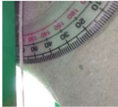
Gambar 21. Kemiringan Sudut Pemasangan SQM
