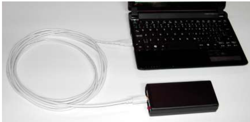
Gambar 6. SQM LU-DL Terkoneksi dengan Komputer Menggunakan Kabel USB
