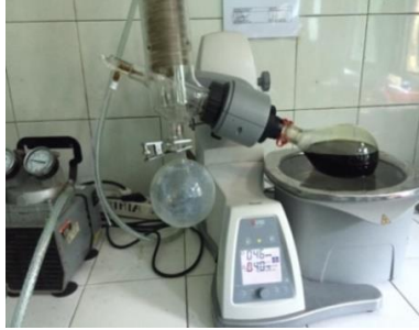
Gambar 4.2 proses penguapan menggunakan rotary evaporator
