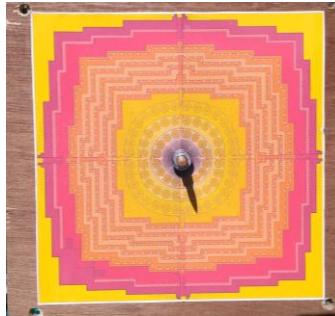
Gambar 4.6: Tongkat Istiwâ' Modifikasi (Sumber: Penulis)
