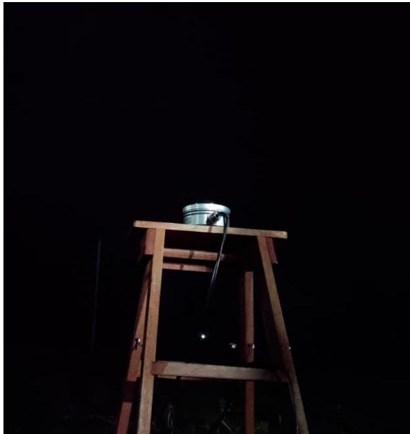
Gambar 18. Pemasangan ASC pada tempat yang datar atau tripod yang telah disediakan.
