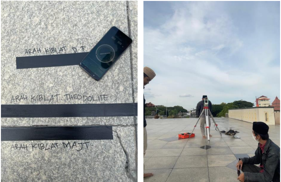
Gambar 4. 2 Praktek Pengukuran Arah Kiblat di pelataran Masjid Agung Jawa Tengah dengan menggunakan Aplikasi Kompas Matarahari Digital Falak dan Theodolite
