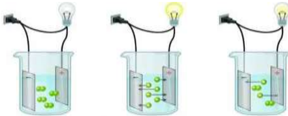
Gambar 2.1 Uji daya hantar listrik larutan elektrolit dan non elektrolit
