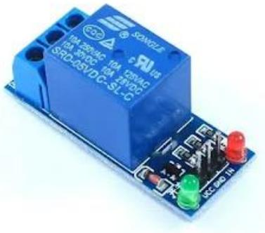
Gambar 2. 9 Modul komponen relay
