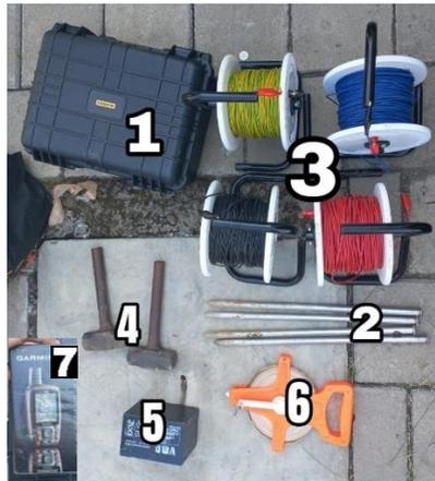
Gambar 3. 2 Satu Set Perangkat Resistivity meter
