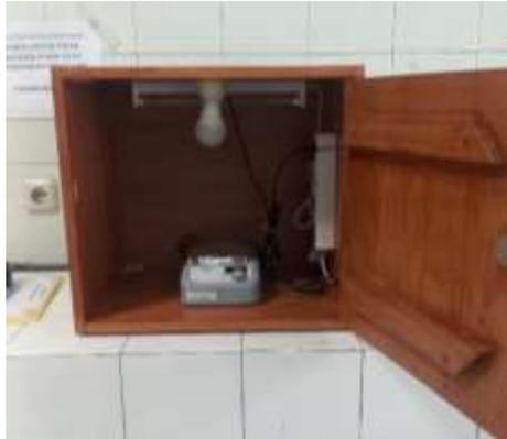
Gambar 4.10 Fotoreaktor untuk fotodegradasi MB
