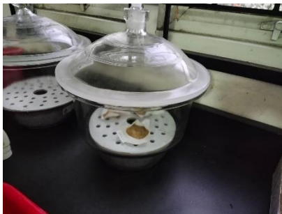
Pendinginan sampel dengan desikator
