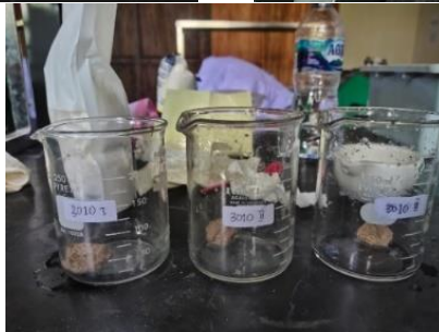
Hasil gluten dari sampel yang telah dicuci
