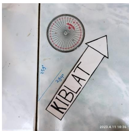
Gambar 4.40: Hasil Pengukuran Arah Kiblat Musala (Camping Ground Hutan Pinus Nglimut) Dengan Menggunakan Segitiga
