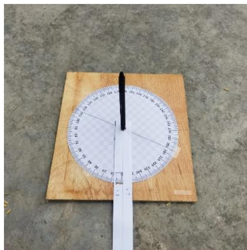
Gambar 4.17: Hasil Pengukuran Arah Kiblat Musala (Gubug Lereng Merangan) Dengan Menggunakan Metode Rasydul Kiblat Harian pada tanggal 29 September 2023 (Sumber:Dokumentasi Pribadi).
