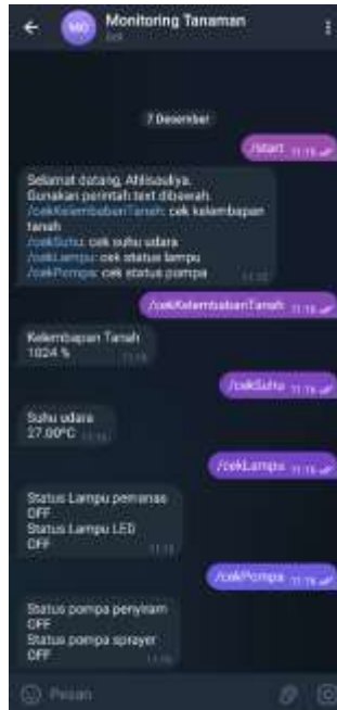
Gambar 4. 8 Pengujian komunikasi bot dengan sistem
