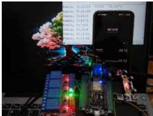
Gambar 4. 6 Pengujian modul timer RTC DS3231
