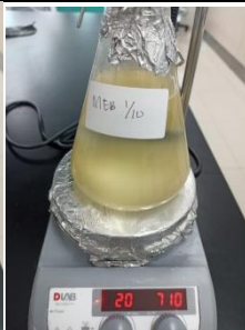
masing-masing media dipanaskan menggunakan hot plate dan diaduk menggunakan magnetic stirrer
