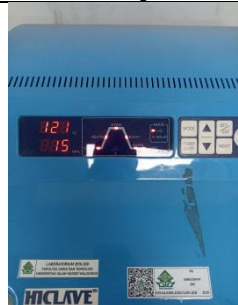
Laurutan NaCl disterilisasi menggunakan autoklaf pada suhu 121°C selama 15 menit
