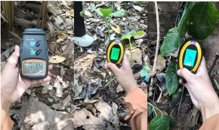
Gambar 4. Pengukuran intensitas cahaya dengan lux meter, pengukuran suhu dan pH tanah dengan soil meter
