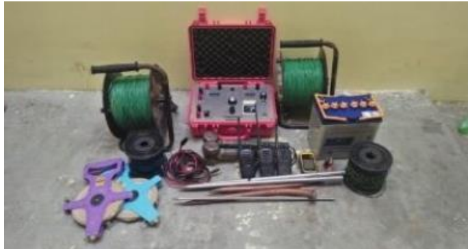
Gambar 3. 2. Peralatan survei geolistrik.
