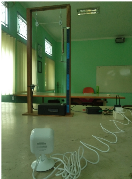
Gambar 4.1 Prototipe Alat Praktikum Konstanta Pegas
