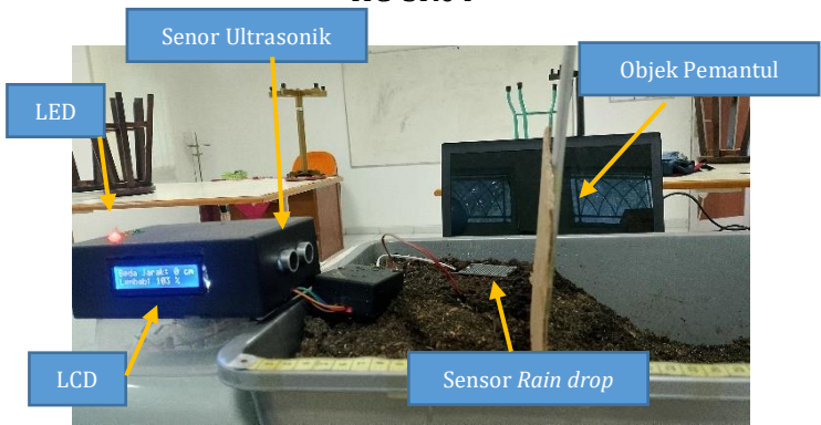
Gambar 4. 4. Proses pengujian sensor ultrasonik HC-SR04
