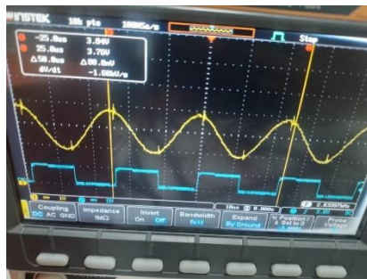
Gambar 4. 3 Hasil Pengujian Tx(Ch2) dan Rx(Ch1)
