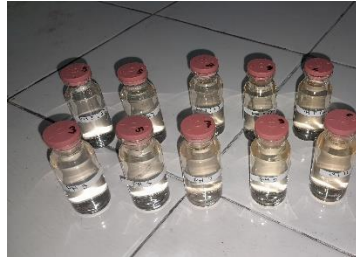
Diuji AAS dengan Panjang gelombang 324,75 nm
