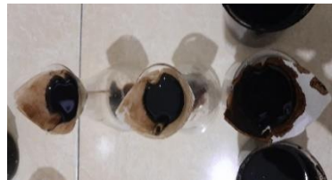
Arang disaring dan dibilas menggunakan akuades sampai pH netral kemudian dioven suhu 250°C selama 5 jam
