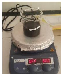
Arang 1gr dimasukkan kedalam air lindi kemudian di stirrer 800 rpm dan divariasikan waktunya selama 15, 30, 60, 90, dan 120 menit masing-masing.
