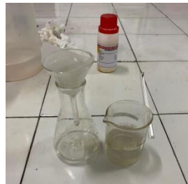
Penyaringan sampel dari proses pengabuan kering
