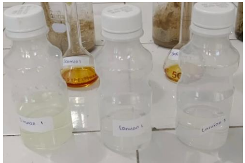
hasil preparasi sampel air yang akan di AAS
