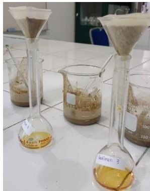
sampel sedimen disaring setelah didapatkan hasil dianalisis dengan AAS
