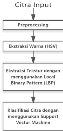
Gambar 3. 1 Diagram blok tahapan penelitian
