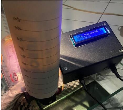
Gambar 4.4 Pengujian sensor ultrasonik
