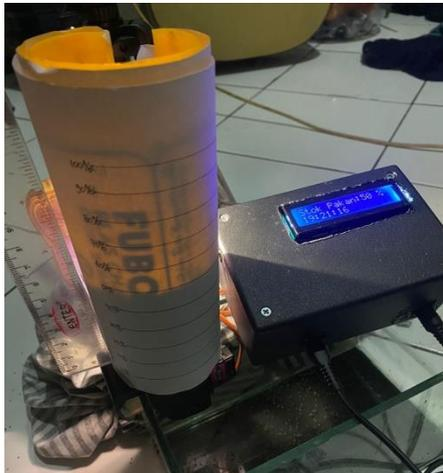
Gambar 4.3 Pengujian sensor ultrasonik
