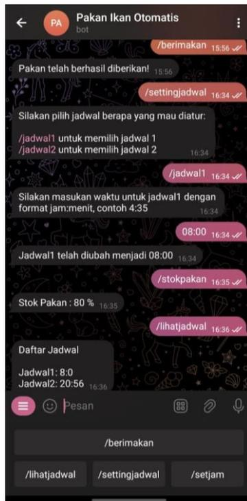
Gambar 4.8 Pengujian bot telegram
