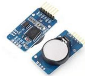
Gambar 2.7 Sensor RTC DS3231
