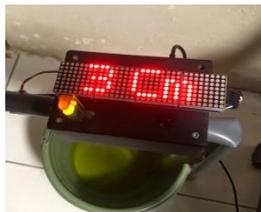
Gambar 4.7 Pengujian Sensor Ultrasonik Ketinggian 3cm
