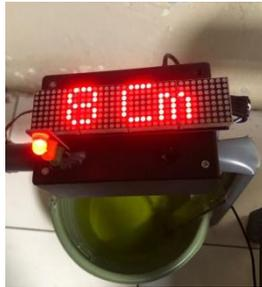
Gambar 4.17 Pengujian Sensor Ultrasonik Ketinggian 8 cm
