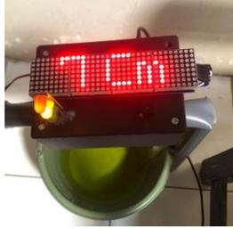
Gambar 4.15 Pengujian Sensor Ultrasonik Ketinggian 7 cm
