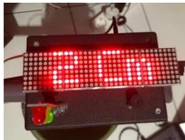
Gambar 4.5 Pengujian Sensor Ultrasonik Ketinggian 2cm
