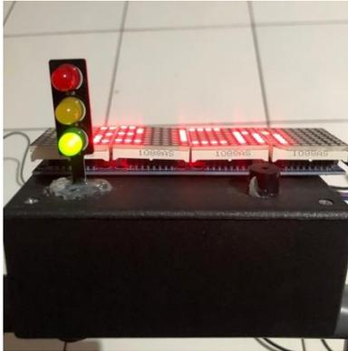
Gambar 4.25 Pengujian Lampu LED berwarna hijau
