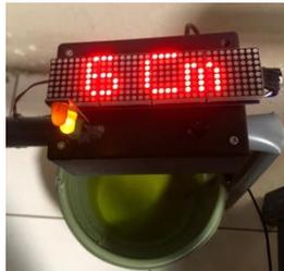
Gambar 4.13 Pengujian Sensor Ultrasonik Ketinggian 6 cm
