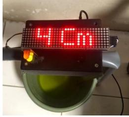
Gambar 4.9 Pengujian Sensor Ultrasonik Ketinggian 4 cm
