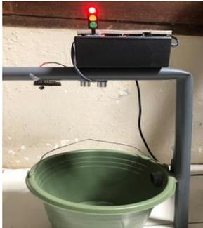
Gambar 4.1 Rangkaian Sistem monitoring dan alat pemantauan ketinggian air
