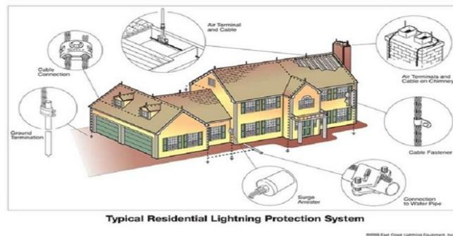
**Gambar 4.38 Sistem Penangkal Petir Konvensional**
