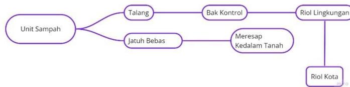
**Gambar 4. 34 Skema Pembuangan Air Hujan**
