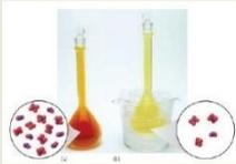
Sebuah labu berisi campuran reaksi kesetimbangan berwarna coklat  $\text{NO}_{2(g)}$  dan  $\text{N}_2\text{O}_{4(g)}$ . Gambar (a) pada  $25^\circ\text{C}$  dan (b) pada  $0^\circ\text{C}$ .
