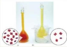
Sebuah labu berisi campuran reaksi kesetimbangan berwarna coklat  $\text{NO}_2(\text{g})$  dan  $\text{N}_2\text{O}_4(\text{g})$ . Gambar (a) pada  $25^\circ\text{C}$  dan (b) pada  $0^\circ\text{C}$ .
