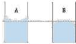
Gambar 1 Miniskus pelarut pada leher labu ukur. (A) Pelarut air membentuk miniskus cekung (B) Pelarut raksa membentuk miniskus cembung (Sutardi dkk, 2020)
