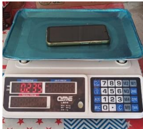
Gambar 0.12. Proses Pengujian Sensor Load Cell
