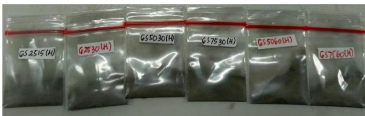
Gambar 4.9 Hasil proses electrorefining untuk mendapatkan timah murni (a) dengan penambahan \text{SnSO}_4 + \text{DI} ; (b) dengan penambahan \text{SnSO}_4 + \text{H}_2\text{SO}_4 .
