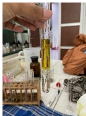
Gambar 4.11 Larutan campuran sampel dengan ammonia pekat, kloroform dan asam sulfat pekat
