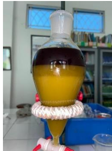
Gambar 4.4 Fraksinasi etil asetat dengan etanol air
