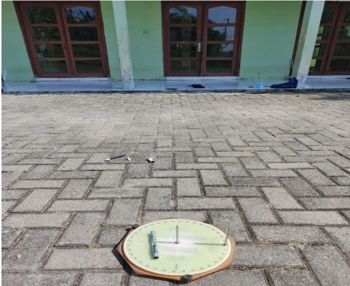
Gambar 3. 4 Hasil pengukuran arah kiblat Masjid Ashabul Kahfi menggunakan Istiwa'ain
