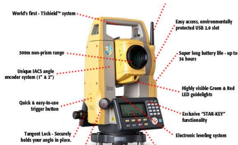
Gambar 4. 5 komponen pada Total Station
