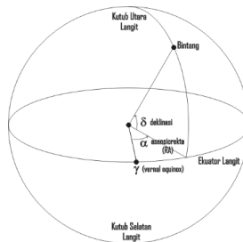
Gambar 3. 4 Letak Deklinasi dan Asensiorekta
