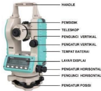
Gambar 4. 4 Komponen pada Theodolite Digital
