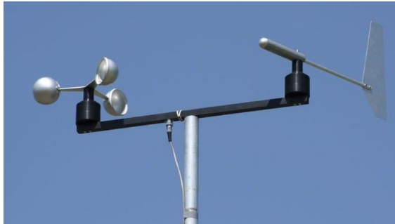
Gambar 2. 6. Alat pengukur arah angin yang disebut dengan Anemometer, memiliki dua komponen Wind Vane dan Cup Anemometer. 30
