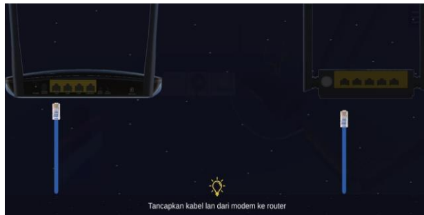
Gambar 4.20 Menghubungkan kabel LAN
