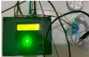
Gambar 4.11 Pengujian Sensor DS18B20 air sumur y
