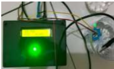
Gambar 4.5 Pengujian Sensor TDS air sumur y
