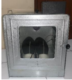
Gambar 4. 22 Tampilan Box Alat Pengering Jenis Sepatu sneakers
