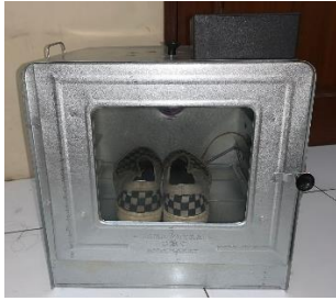
Gambar 4. 26 Tampilan Box Alat Pengering Jenis Sepatu Kets
