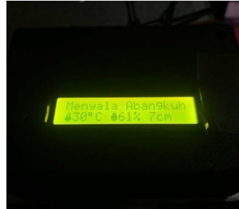
Gambar 4. 15 Hasil Pengujian Sensor Ultrasonik Sepatu Pantovel
