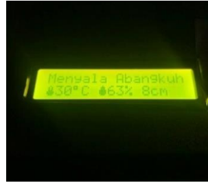
Gambar 4. 11 Hasil Pengujian Sensor Ultrasonik Sepatu sneakers
