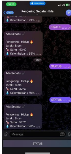
Gambar 4. 7 Proses dan Hasil Pengujian Komunikasi Data Sistem Monitoring Alat Pengering Sepatu Otomatis
