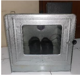
Gambar 4. 30 Tampilan Box Alat Pengering Jenis Sepatu Pantovel
