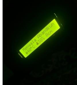
Gambar 4. 17 Hasil Pengujian Sensor DHT11 Sepatu sneakers
