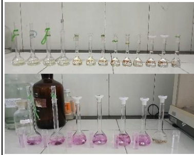
Uji adsorpsi pada optimasi kondisi (atas: sebelum; bawah: setelah penambahan 1,5 difenilkarbazida dan didiamkan selama 8 menit)
