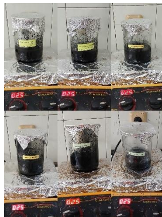
Modifikasi 30 g arang aktif (AA) dan arang teraktivasi (AAT) dengan CTAB konsentrasi 0,92; 1,84; 2,76 mM (1:5)
