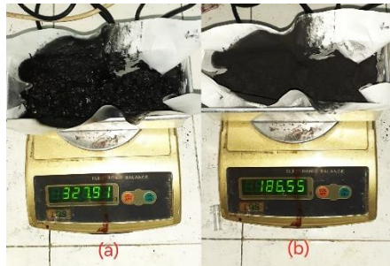
Gambar 4.3 Tahap Preparasi Tempurung Kelapa (a) Setelah Aktivasi dengan H_3PO_4 dan Pembilasan hingga pH Netral, (b) Setelah Dioven Suhu 105^\circ C (Dokumentasi Pribadi)
