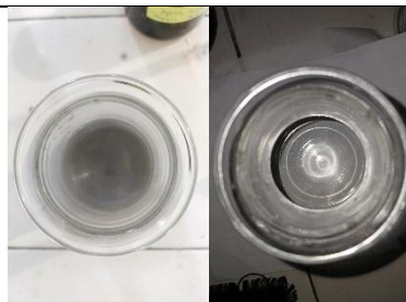
Filtrat AA dan AAT tidak terbentuk endapan putih setelah diuji dengan \text{AgNO}_3
