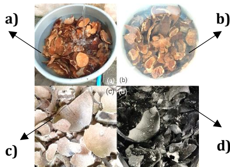
Gambar 4.1 Tahap Preparasi Tempurug Kelapa a) Pencucian dengan Air Biasa, b) Pencucian dengan Akuades, c) Pengeringan, dan d) Karbonisasi (Dokumentasi Pribadi)
