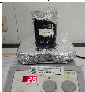
Aktivasi 200 g arang 100 mesh dengan \text{H}_3\text{PO}_4 40%, perbandingan 1:2
