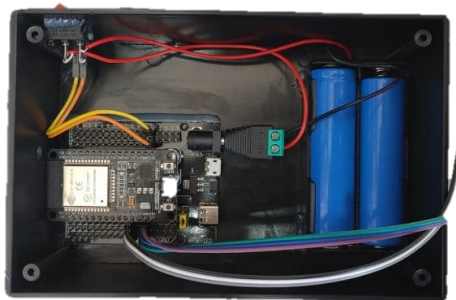
Gambar 3.17: Penampakan Instalasi Teleskop Altazimuth berbasis ESP32 (Sumber: Dokumen Pribadi)
