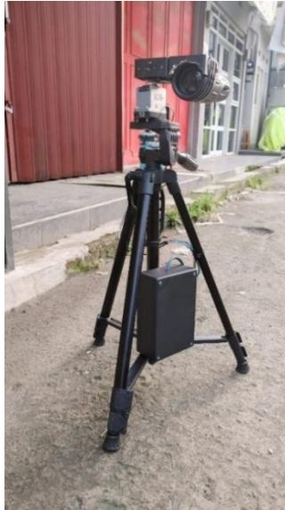
Gambar 3.18: Teleskop Altazimuth berbasis ESP32 tampak dari samping (Sumber: Dokumen Pribadi)
