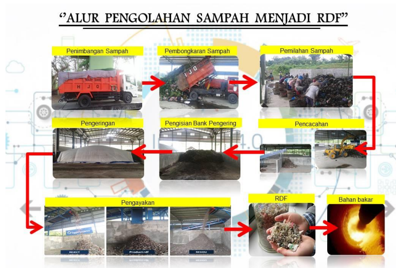
Gambar 2.4. Alur pengolahan sampah RDF di Cilacap, Jateng.
