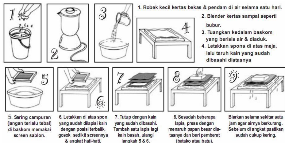
Gambar 2.7 Proses daur ulang kertas secara manual
