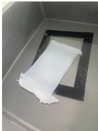
Proses pelepasan membran dari plat kaca
