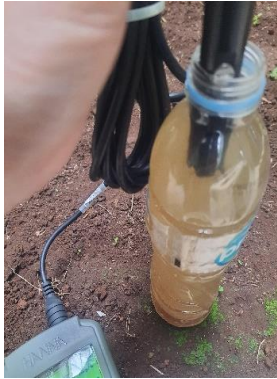
Pengukuran Do meter
