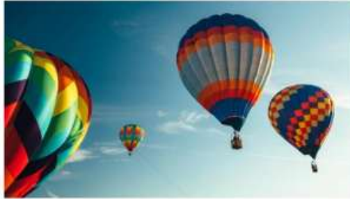
Gambar 34. Saat balon udara dipanaskan balon terdorong naik dan bisa melayang di udara.
