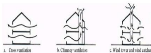
Gambar 2.6.3.1 Penggambaran Sistem Penghawaan Alami Sumber: Widera, 2015. P. 569
