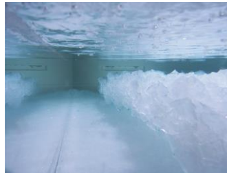
Gambar 2.7. Dinding lemari es yang mengkristal.
