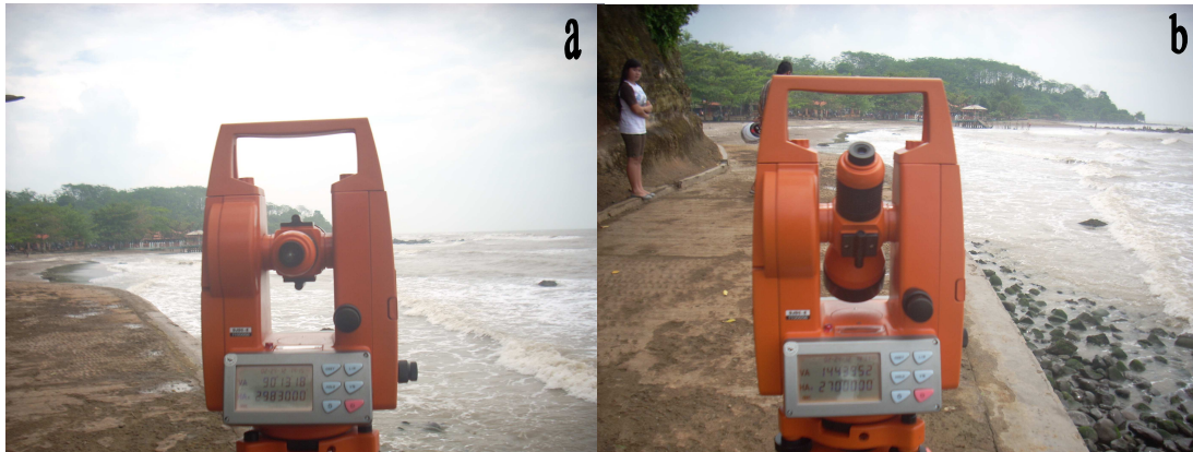
Gambar 3.7a : Observasi menggunakan theodolit menunjukkan bahwa pada azimuth 298^{\circ}30' terdapat penghalang berupa bukit.
