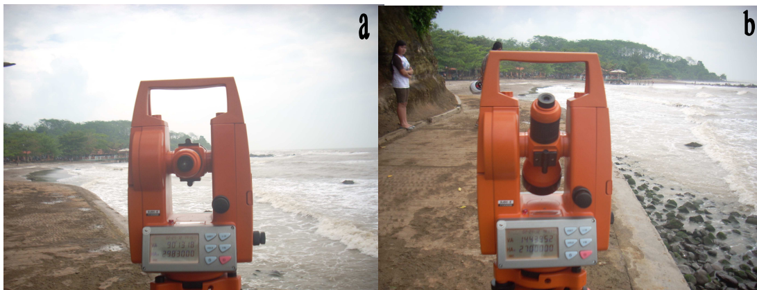
Gambar 4.1a : Observasi menggunakan theodolit menunjukkan bahwa pada azimuth 298^{\circ}30' terdapat penghalang berupa bukit.
