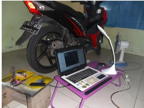
Gambar 4. 11 Pengujian Sensor MQ-135 Dengan Emisi Kendaraan Bermotor
