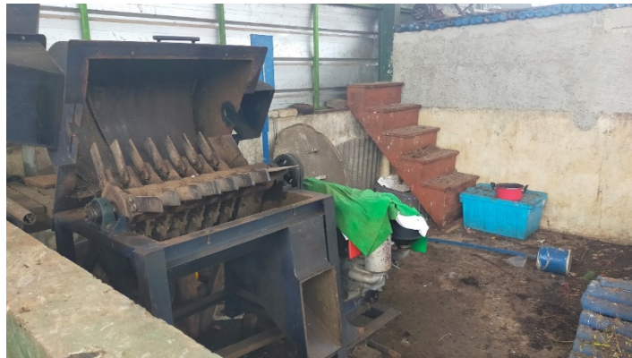
(mesin pencacah, untuk mencacah sampah organik dalam pembuatan pupuk kompos)
